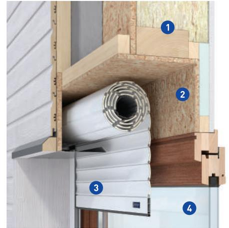
Place réservée dans l'épaisseur du bardage d'une Maison Ossature Bois enroulement vers l'extérieur
