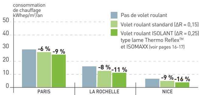
La performance thermique de l'ensemble du volet roulant et de son coffre joue un rôle prédominant dans la diminution de la consommation de chauffage. Le gain s'échelonne **entre 6 et 16 %** selon la performance thermique du volet.
